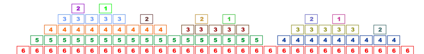
Rysunek 3. Stos wywołań odpowiadający obliczeniu wyrażenia FibonacciRek(6) . Symbol \boxed{x} jest uproszczonym zapisem rekordu aktywacji /ramki - tutaj odczytujemy go jako „obliczanie FibonacciRek(x) trwa”.
